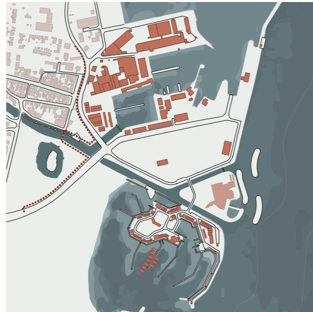
Markerede bygninger ligger udenfor den faste sikring og skal derfor sikres lokalt - både individuelt og sammen, hvor det giver mening. Kattegatcenteret får udført lokal sikring.
